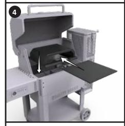
Instale el horno y la piedra para pizzas. La piedra para pizzas sobresaldrá del borde fronta del horno.
